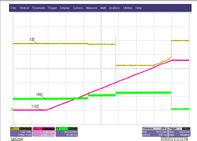
R_{ISET} = 1.5\text{ k}\Omega V_{SET} = 3.6\text{ V} Input source I_{limit} = 25\text{ mA}
